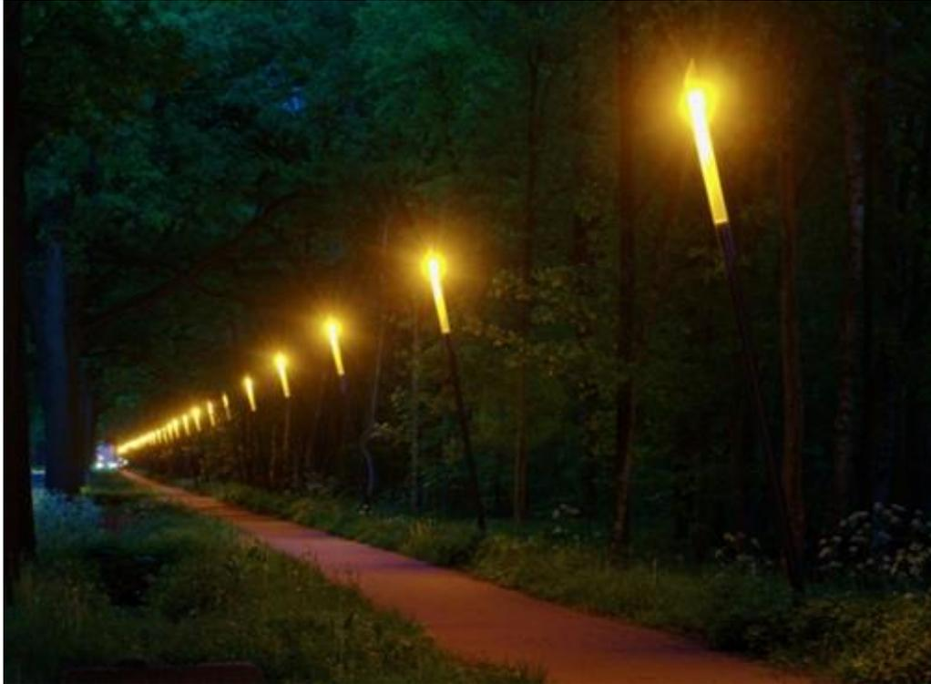
**Piste cyclable éclairée par des LEDs à détecteur de mouvement traversant une zone sensible, le long de la N117 dans la province d'Anvers.**
