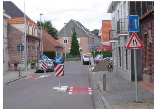
Chicane avec bypass → pas faisable si stationnement de part et d'autre
