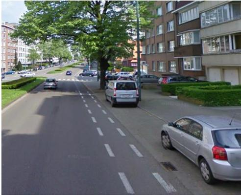
Une piste cyclable marquée est une partie de la route exclusivement réservée aux cyclistes par des marquages. Les véhicules ne sont pas autorisés à y rouler ni à s'y garer, et les cyclistes sont contraint de l'utiliser sauf exception : si changement de direction, si piste dégradée,...
