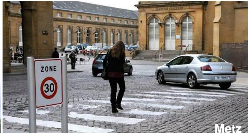
Pour l'intérieur de la zone, il suffit souvent d'un rappel à l'aide de petits panneaux et de peinture, ce qui n'exclut nullement des aménagements légers (chicanes, parkings alternés sur la voirie,...) aux endroits où les vitesses observées sont élevées.
