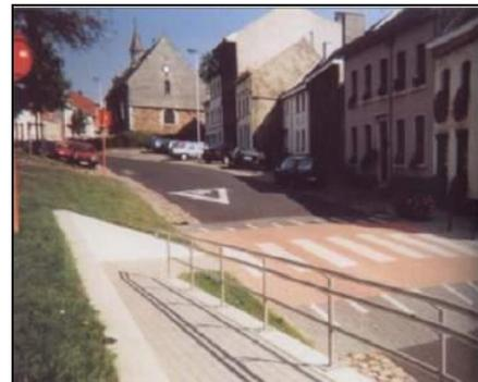
C'est l'occasion d'élargir les trottoirs, ce qui permet de rétrécir les bandes de circulation incitant l'automobiliste à ralentir. En effet le rayon de courbure de la trajectoire possible se trouve diminuer ce qui force le véhicule à effectuer sa manœuvre de tourne-à-droite lentement.
