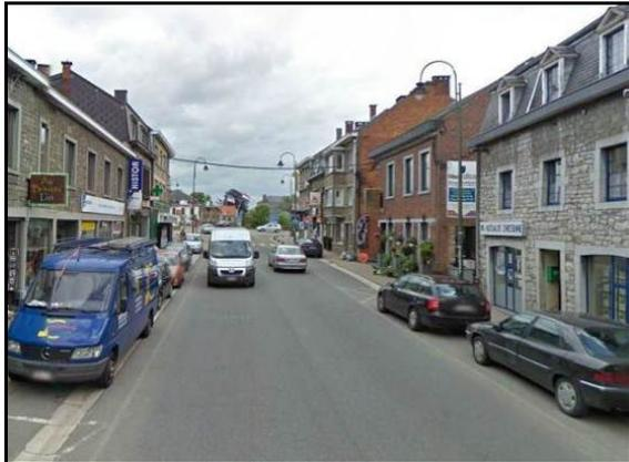
Section urbaine à Hotton. Bande de roulement en bon état, absence de marquage au sol et stationnement longitudinal de part et d'autre de la chaussée.
