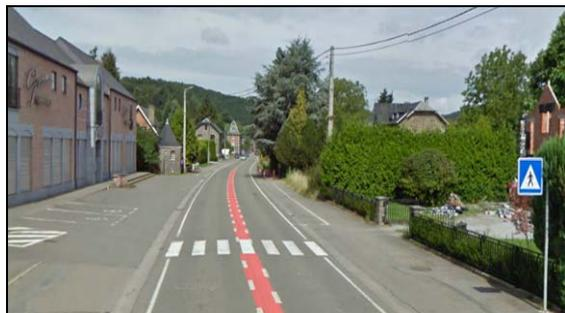
Section en direction de Hotton. On remarque la présence d'un rétrécissement de la voirie et l'aménagement d'une traversée marquée et signalée.
