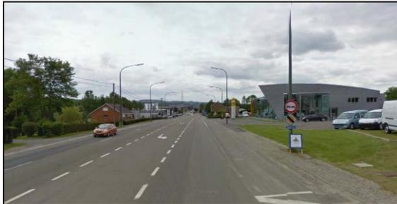
En entrée de Marche-en-Famenne, le profil évolue du profil routier à un profil plus urbain. Deux bandes en sortie de Marche-en-Famenne, une bande en entrée et des ilots centraux.
