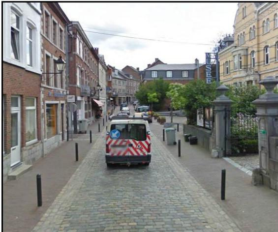
Section en hypercentre. Le profil est en 1x1 voie de  $\pm 3,5$  m. Le revêtement est pavé. Les trottoirs sont à niveaux avec la chaussée séparés par des potelets.
