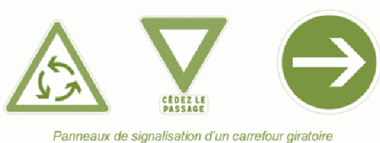
Panneaux de signalisation d'un carrefour giratoire
