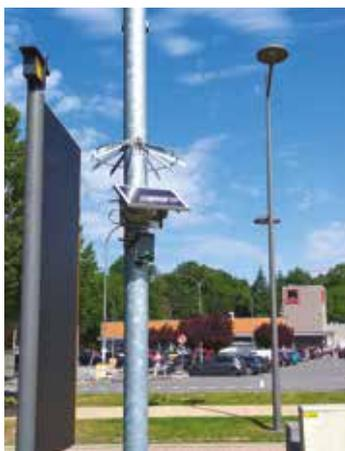
Ces 18 stations installées en juin et juillet, sur des pylônes/poteaux à 3 mètres de hauteur, possèdent plusieurs capteurs. Ces capteurs mesurent, en temps réel, les principaux polluants, à savoir :
