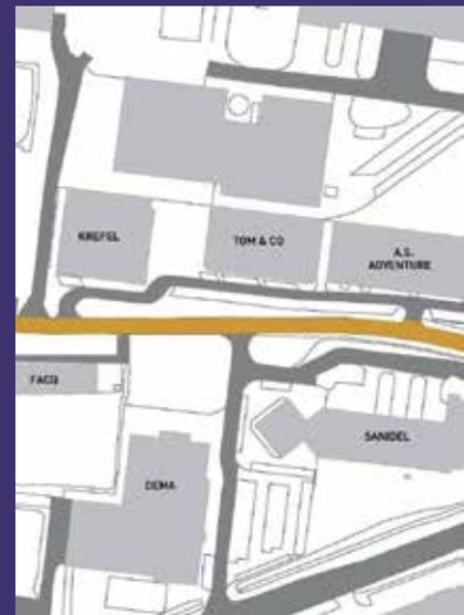
Trois phases d'aménagement sont proposées. Celles-ci passent entre autres par la mise à 50 km/h de l'axe depuis le rond-point jusqu'à l'accès à la caserne des pompiers ; une berme centrale sur la première partie pour empêcher les mouvements de tourne-à-gauche en sortie des parkings ; cheminements confortables pour les modes doux ; création d'un effet de porte au futur rond-point du contournement.
