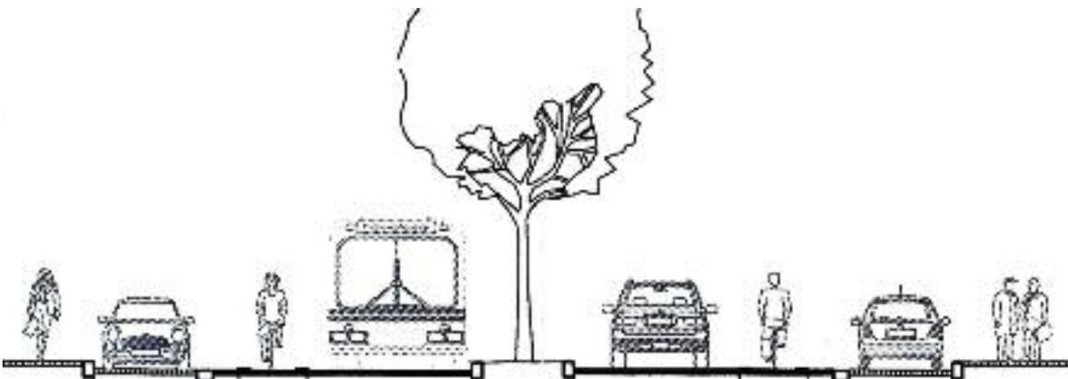
De gauche à droite : un trottoir de largeur variable en fonction des lieux (en pavés de béton rouge), une zone de parking délimitée de 2 m de large (en pavés de béton gris), une bande de sécurité et de manœuvre de 0,8 m, une piste cyclable délimitée de 1,3 m en asphalté, une bande de roulement de 3,2 m en asphalté pour véhicules, une zone de délimitation décorative de 2 m... Ensuite, même disposition en sens inverse pour l'autre sens de circulation.
